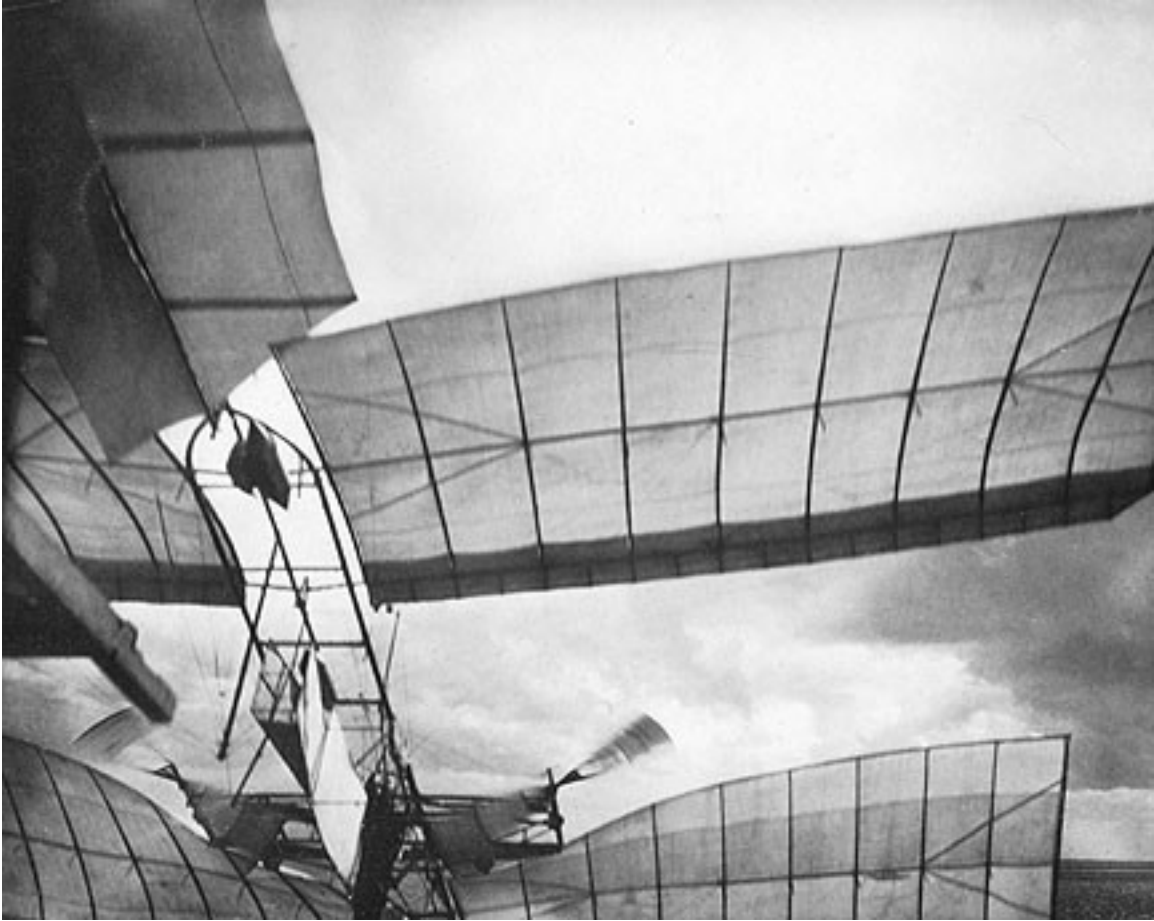
Аerodrome A перед стартом. Хлипкость конструкции хорошо заметна
