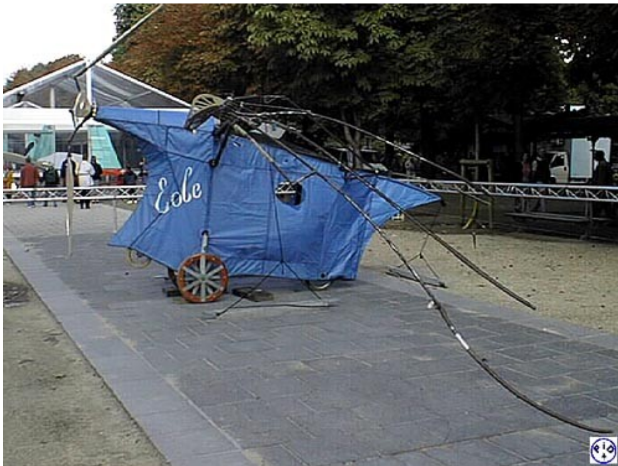
Современная реплика "Эола"; с крыла снята обшивка.
