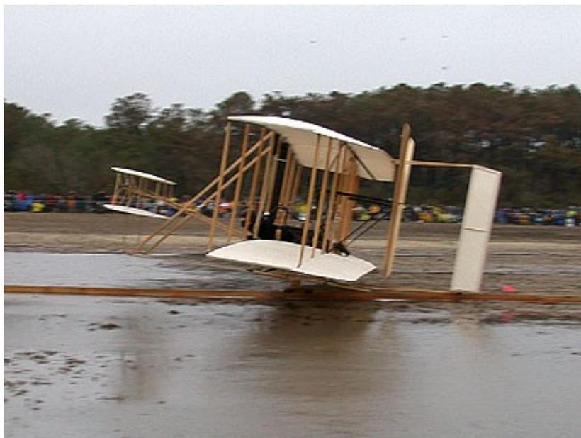
*Неудачная попытка взлета реплики в 2003. Впрочем, ей помешала погода - в 4-й цилиндр двигателя попала дождевая вода*
